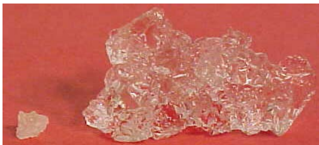
Gránulo de SEHUSORB W-300 antes y después de hidratación.
